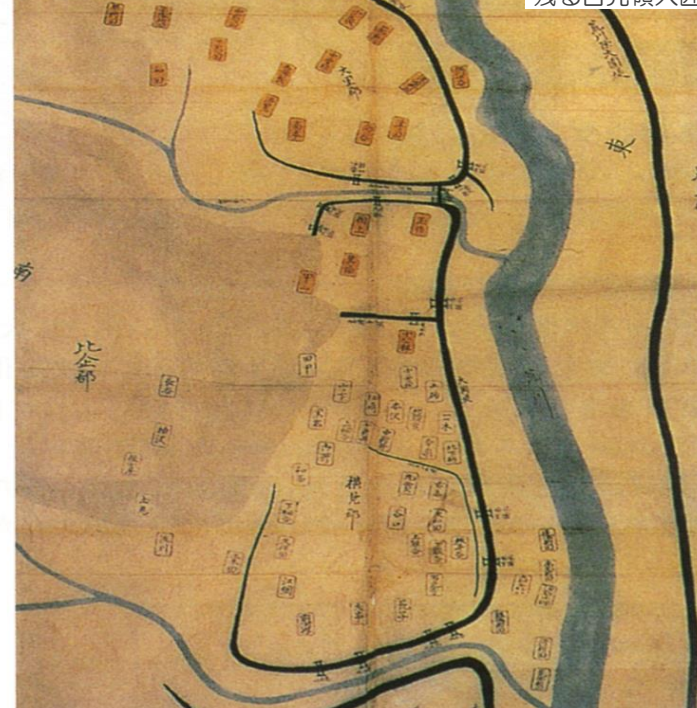
水害に備えて集落を輪のように囲む大田堤を整備 絵図は江戸時代に描かれたもの(現 埼玉県熊谷市吉見町、大里村)
